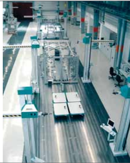
Aufspannplattenfeld für Horizontalarm-Messanlage
